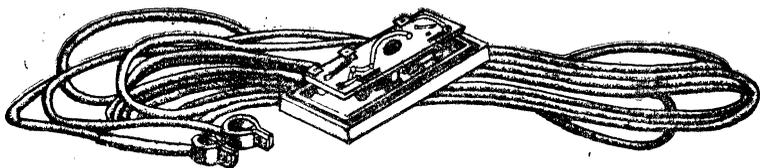
Рис. 4. Делитель напряжения.
