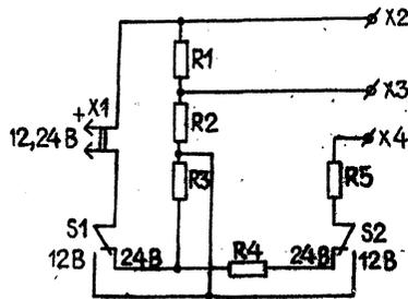
Рис. 2. Схема делителя напряжения электрическая принципиальная.
