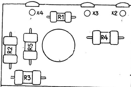
Рис. 4. План размещения элементов делителя напряжения.
