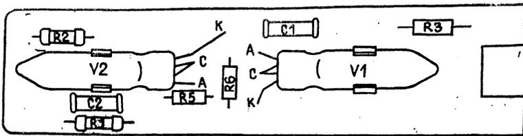
Рис. 3. План размещения элементов блока детектирования У4.
